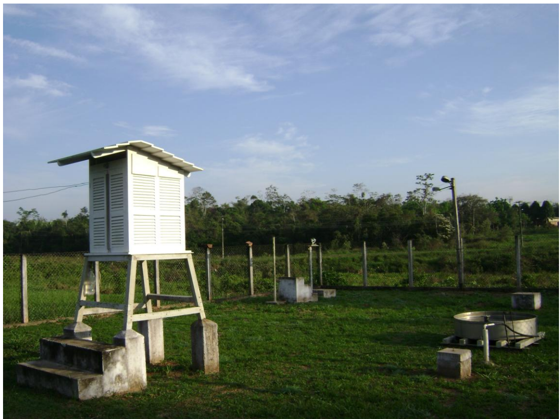
FIGURA 1 - Estação Climatológica Principal do Instituto Nacional de Meteorologia (INMET) instalada na Universidade Federal do Acre, no município de Rio Branco-AC. Fonte: Souza, 2008.
