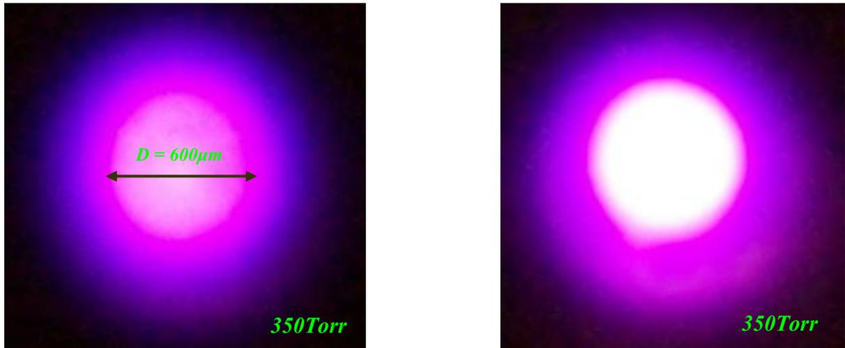
Figura 4.28: Fotografias digitais comparando a emissão luminosa através da descarga de catodo oco operando no modo normal (esquerda) e da descarga de catodo plano (direita).
