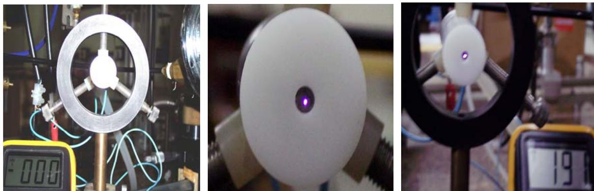
Figura 4.48: Descarga de microcatodo oco operando em ar atmosférico, para furo com diâmetro  $D = 250\mu\text{m}$ , eletrodos de Mo com  $100\mu\text{m}$ , fluxo de gás argônio  $\Phi = 200\text{sccm}$  e tensão de descarga de  $191\text{V}$ , para uma corrente elétrica de  $2,5\text{mA}$ .
