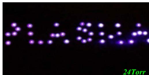
Figura 4.31: Associação em paralelo de microdescargas CBL, em níquel ( $20\mu m$ ), furos com diâmetro  $D = 200\mu m$ , operada em Ar na pressão de  $24Torr$ .
