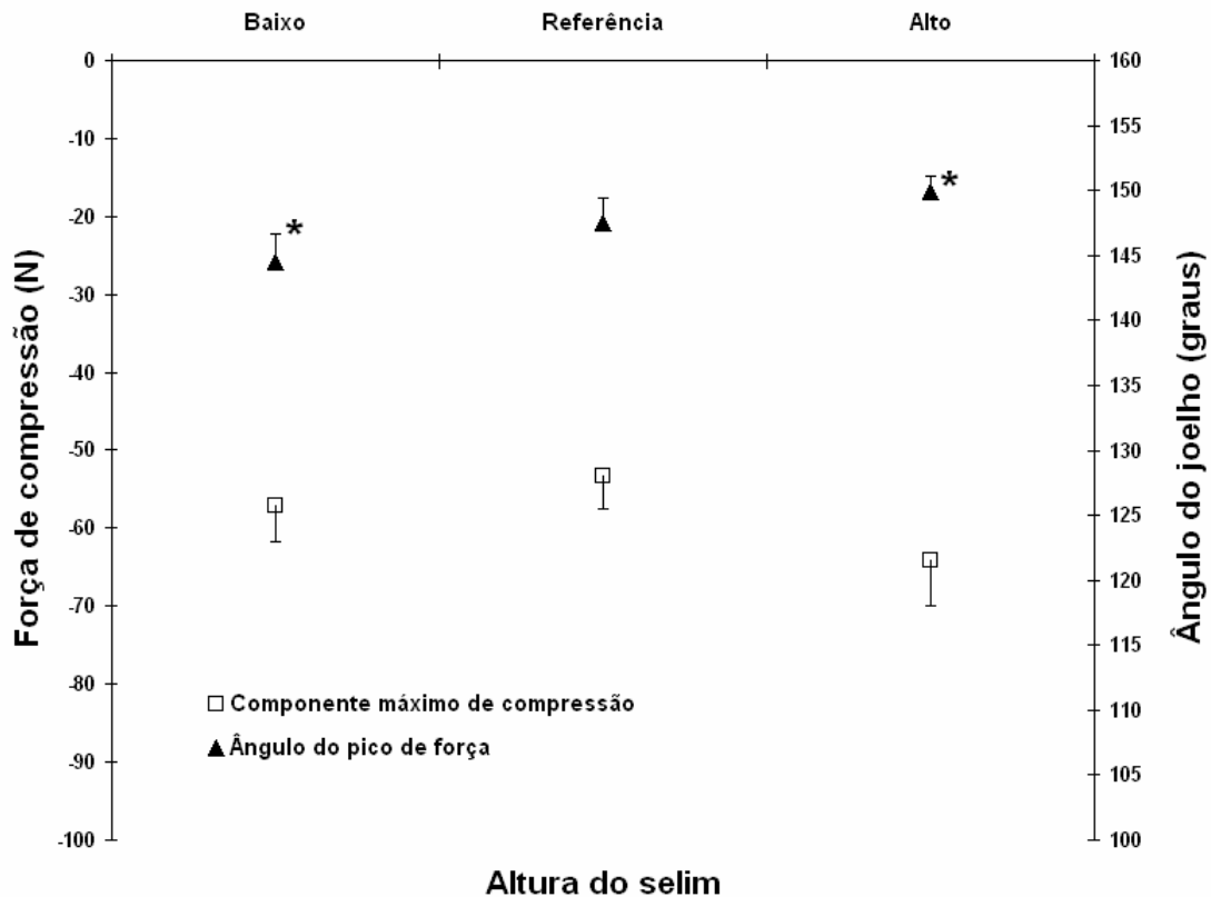
Figura 9 - Força de compressão e respectivos ângulos do joelho em função das posições do selim. Houve diferença significativa no ângulo do joelho entre a posição 3 cm para cima e 3 cm para baixo (* p = 0,035 ).
