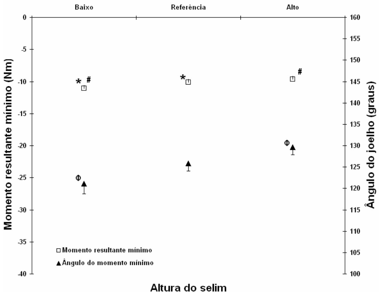
Figura 22 - Momento resultante mínimo tibiofemoral e respectivos ângulos de ocorrência no joelho em função da altura do selim. Houve diferença significativa entre a posição 3 cm para baixo e a posição de referência (* p < 0,001 ) e entre a posição 3 cm para baixo e a posição 3 cm para cima (# p < 0,001 ). Houve diferença no ângulo de ocorrência do momento resultante mínimo entre a posição 3 cm para baixo e 3 cm para cima ( ^{\Phi}p = 0,001 ).
