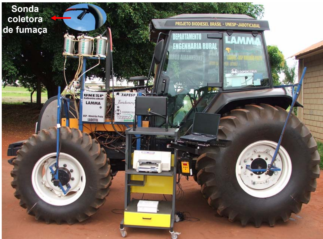
FIGURA 6. Vista geral do trator instrumentado para o ensaio de opacidade da fumaça.
