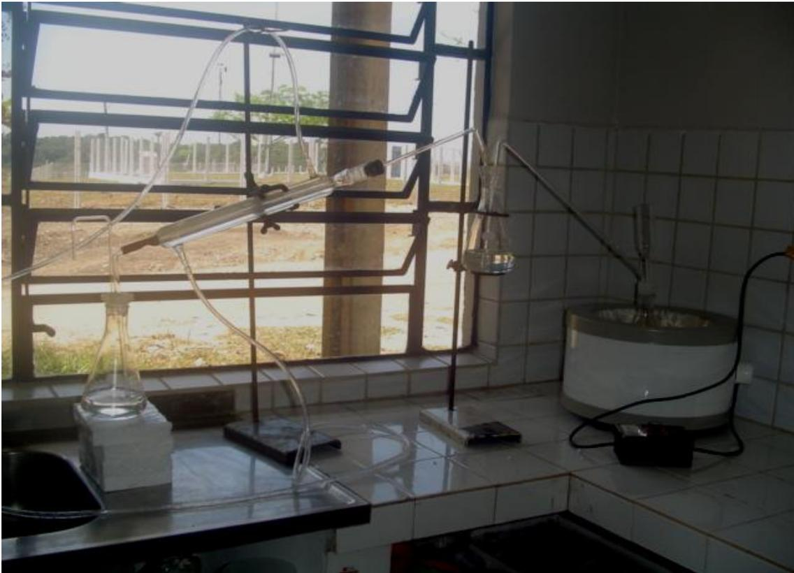
**Figura 2.** Aparato instalado com arraste de vapor para avaliação dos compostos cianogênicos em macaxeira ‘Pernambucana’.
