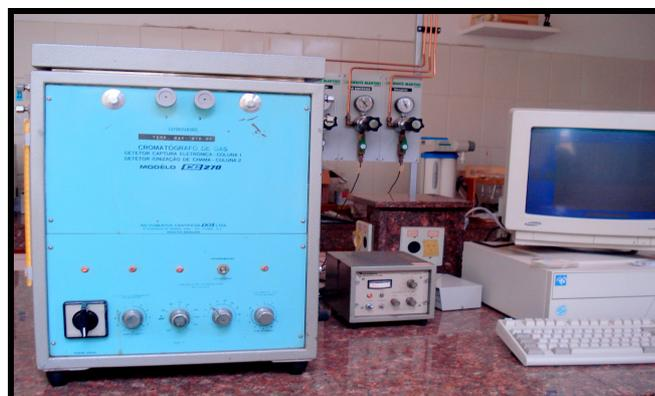
**Figura 9.** Cromatógrafo a gás para determinação de AGCC.
