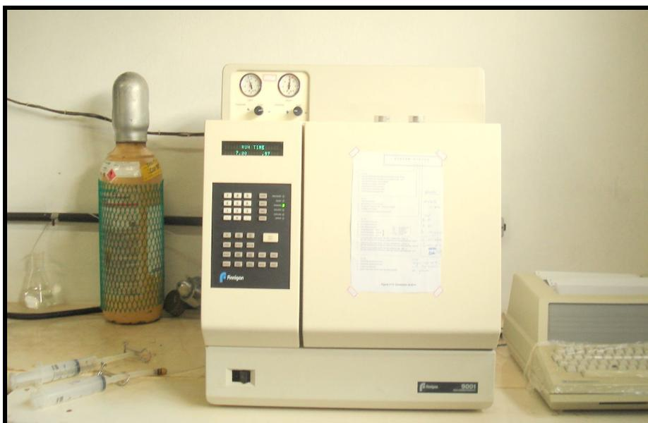
**Figura 8.** Cromatógrafo gasoso e seringa plástica contendo a amostra de gás a ser injetada.
