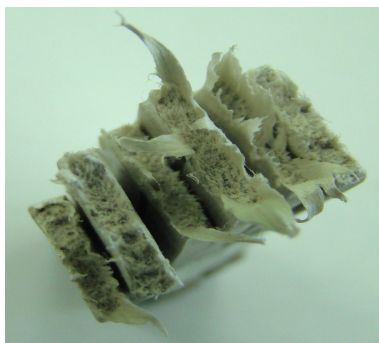
Figura 4.13 Corpos de prova de tração CM40% após fratura
