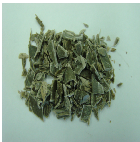
(a) (b) Figura 3.5 (a) Moinho granulador; (b) compósito moído
