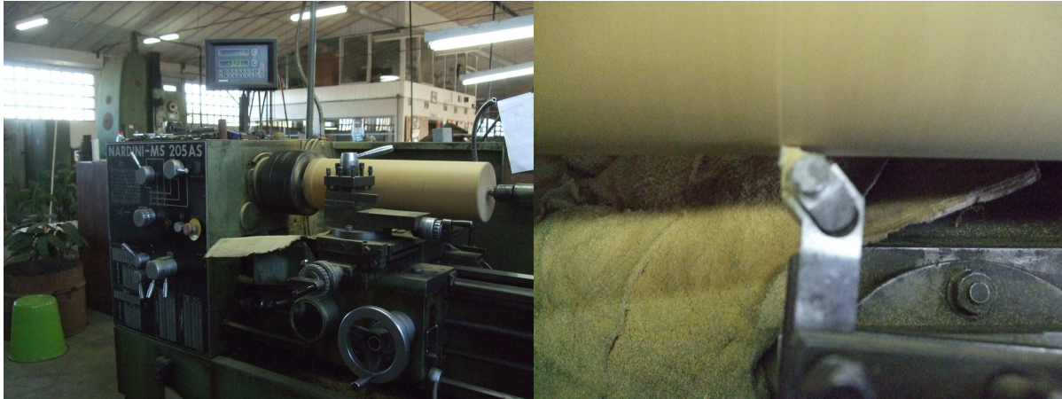
Figura 20: Apresenta a montagem completa e a ferramenta durante o processo de usinagem.
