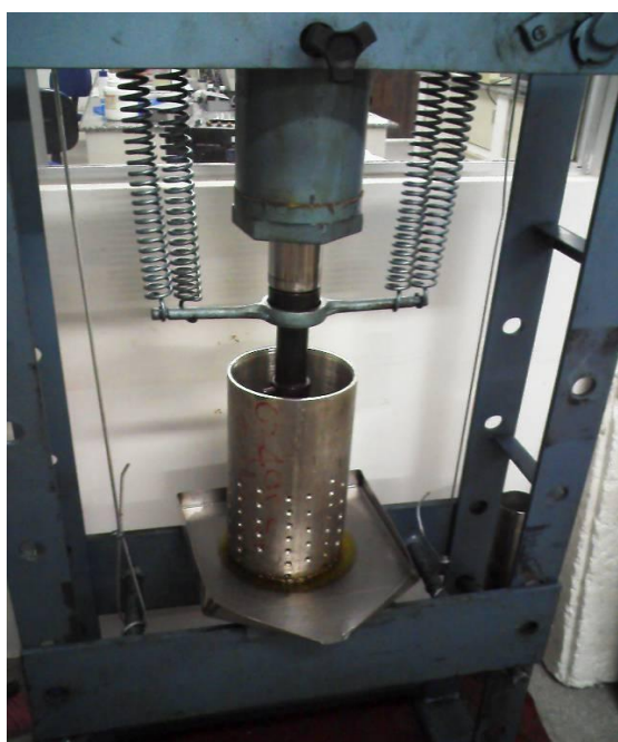
Figura 12 – Extração do óleo de linhaça por prensagem a frio.
