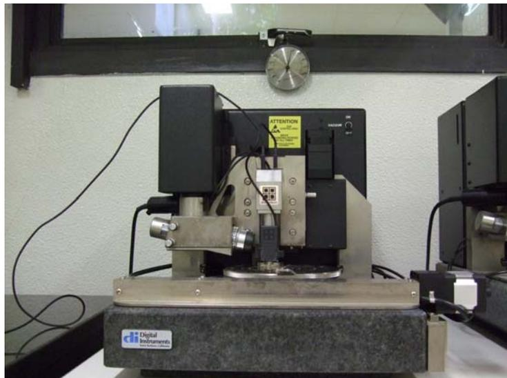
FIGURA 3.5: Fotografia ilustrativa do equipamento utilizado nos testes de nanoindentação.
