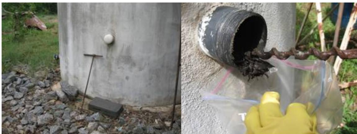
Figura 3.6: Vista do trado helicoidal e coleta de amostra de sólidos.
