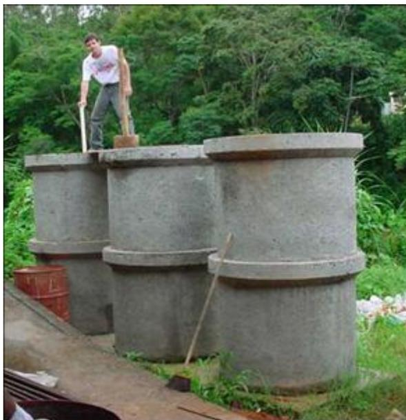
Figura 2.7: Aterros simulados em concreto (Barros, 2004).
