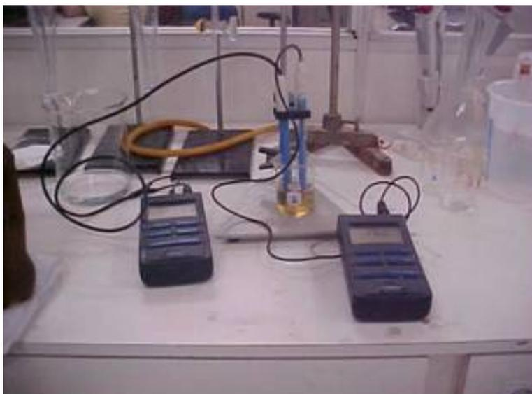
Figura 3.11: Determinação de Eh e pH no lixiviado.
