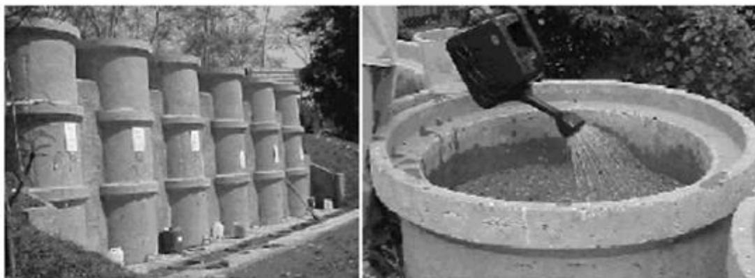
Figura 2.14: Vista dos lisímetros e do procedimento de recirculação (CARVALHO et al, 2006).
