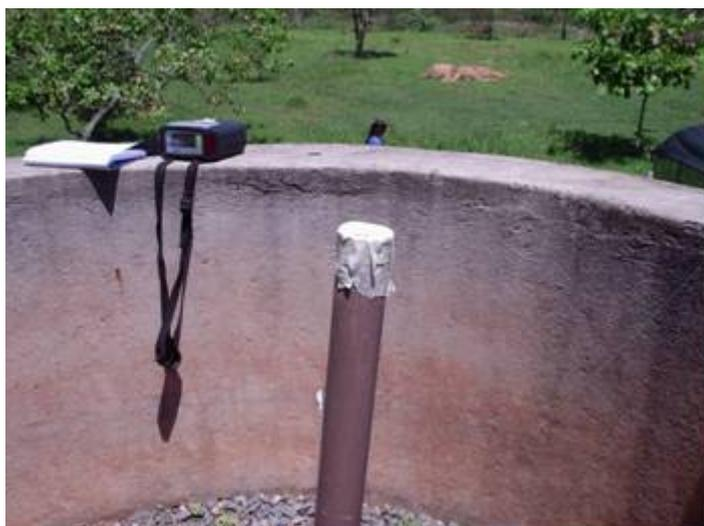
Figura 3.4: Visão do dreno de gás e do detector multigás.
