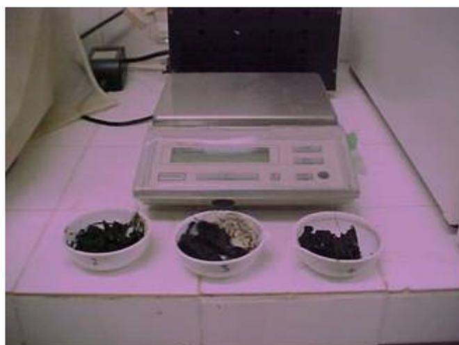
Figura 3.8: Amostras antes da determinação do teor de umidade.
