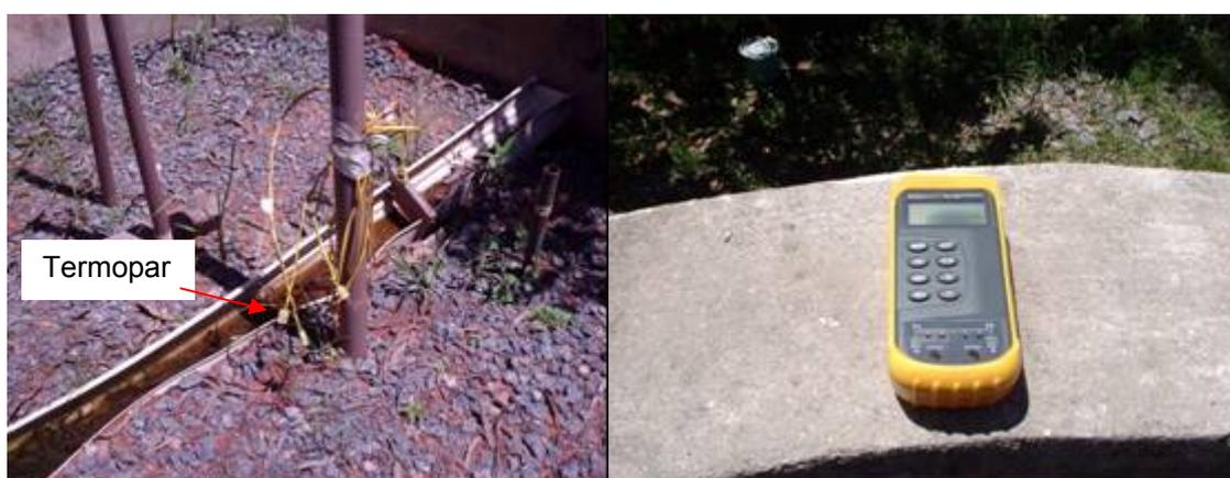
Figura 3.5: Vista dos termopares e termômetro digital.
