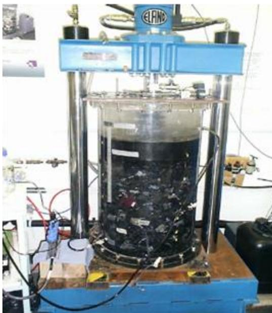
Figura 2.12: Reator anaeróbio para tratamento de resíduos orgânicos (White et al., 2005).
