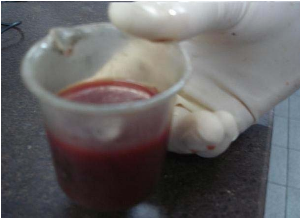
Figura 3.3: Banho residual de remolho da pele verde
