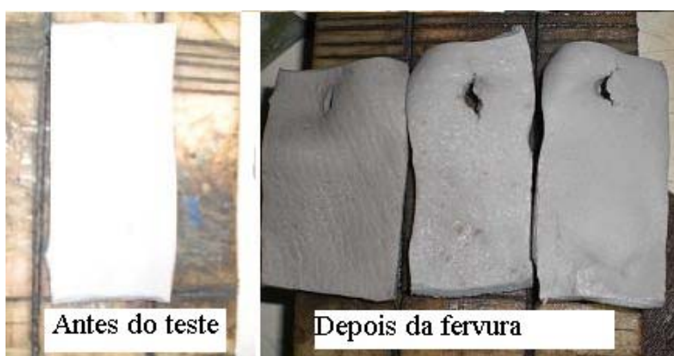
Figura 4.5: Teste de retração do couro realizado com a formulação com redução do experimento II
