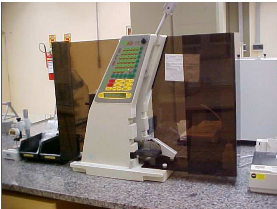
Figura 3.10: Equipamento para resistência ao impacto Izod (IPQ, 2003)
