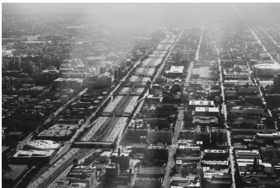
Fig. 8 Pista expressa (Eisenhower) com ramal ferroviário no canteiro central.
