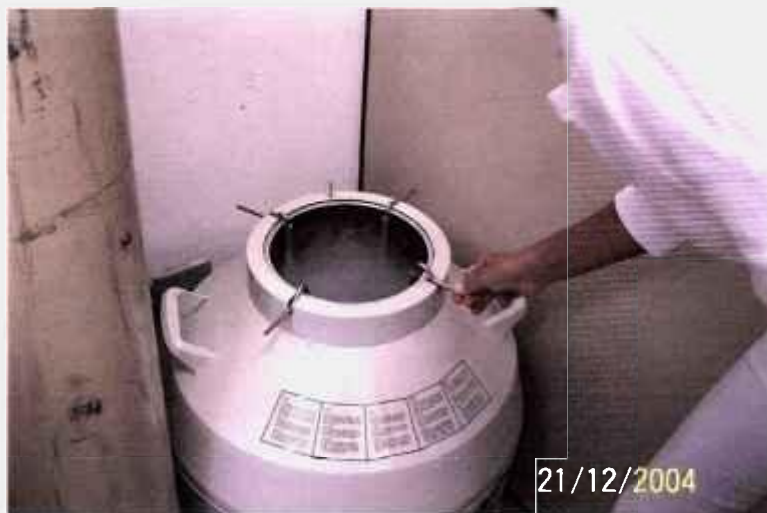
Figura 2: Descongelamento. Remoção das células do nitrogênio líquido
