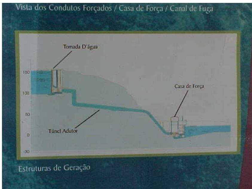
**Foto 32** – Esquema de geração de energia da PCH de Pedra do Cavalo - 2005.
