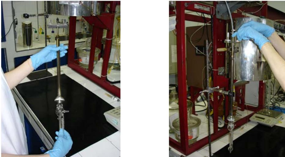
Figura 15 – Conexão do condensador ao reator e deste ao fornecimento de gás nitrogênio
