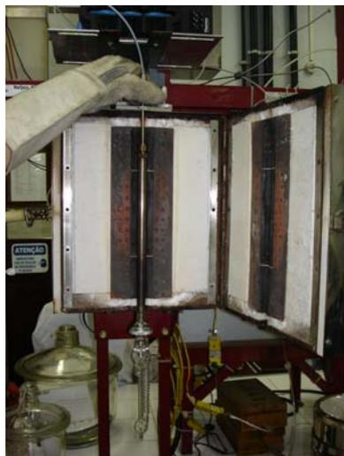
Figura 16 – Colocação do reator dentro do forno da unidade MAT
