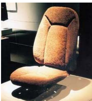
Figura 13 - banco para automóveis com fibra de coco (Projeto B1)
