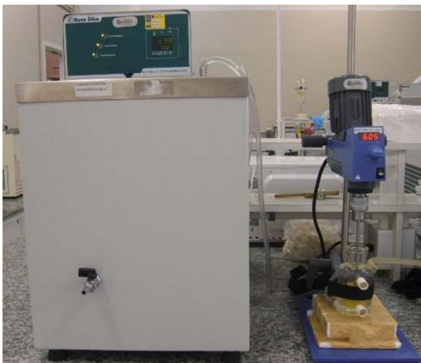
Figura 4 - Vista da unidade experimental utilizada na reação de glicerólise enzimática.
