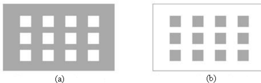
Figura 2.3 – Tipos de elementos de uma FSS. (a) Elementos do tipo abertura. (b) Elementos do tipo patch condutor.
