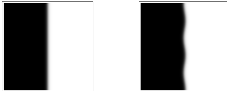
Figura 3.1: Diagramas mostrando as duas fases do campo (uma em preto e a outra em branco) separadas por uma interface (a estreita região difusa). Na figura da esquerda, a interface está localizada; na outra, o centro da interface flutua devido às chamadas ondas capilares. Sendo em d = 2 , o perfil de deslocamento do centro da interface é uma linha.
