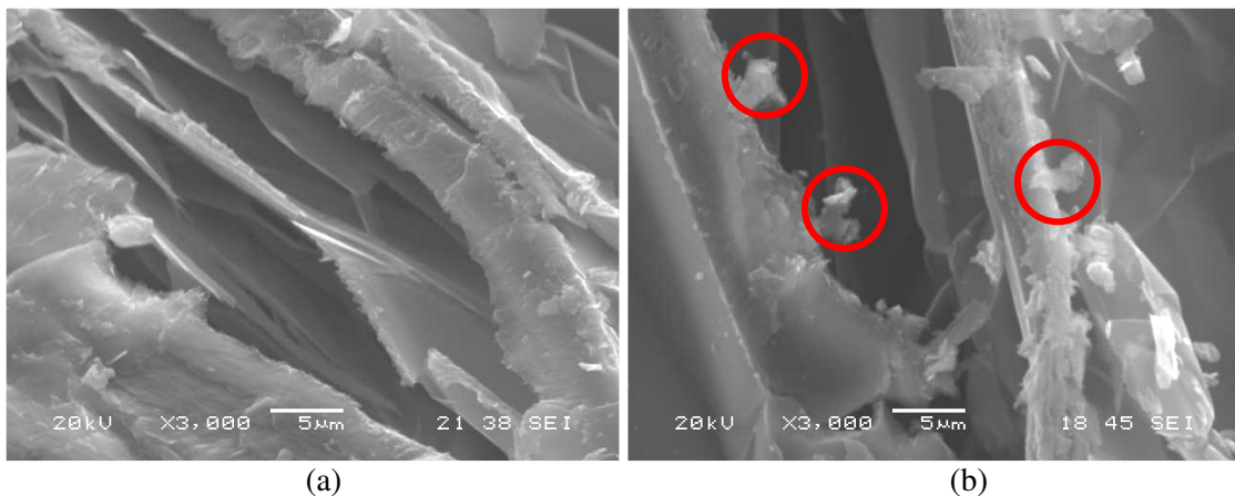
Figura 4.17. Fotomicrografias da amostra de vermiculita fina do Piauí com aumento de 3000 vezes (a) expandida, (b) hidrofobizada.
