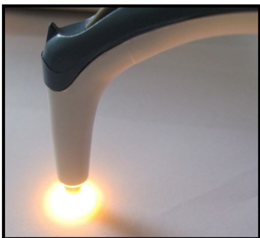
Figura 4.6 – Posicionamento correto da sonda do espectrofotômetro sobre o corpo de prova
