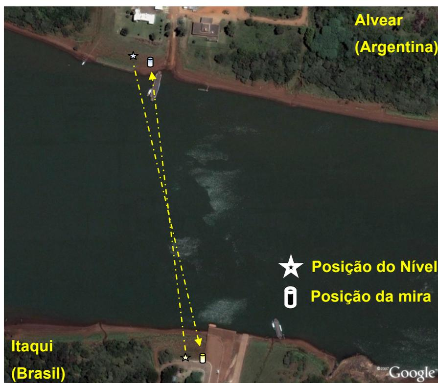
FIGURA 39 - ESQUEMA DO NIVELAMENTO DE TRAVESSIA.
