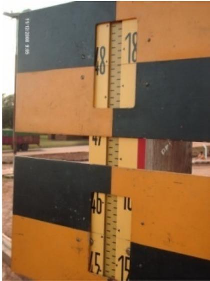
FIGURA 11 - VISORES UTILIZADOS NO NIVELAMENTO DE TRAVESSIA.
