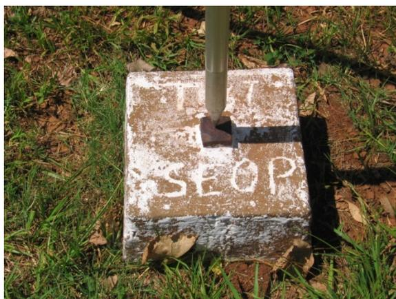
FIGURA 38 - MARCO VINCULADO AO NIVELAMENTO GNSS E TRIGONOMÉTRICO E SUPOSTAMENTE AO DE TRAVESSIA.
