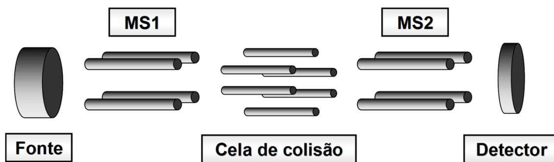
FIGURA 15. Esquema de um analisador de triplo-quadrupolo (QqQ).
