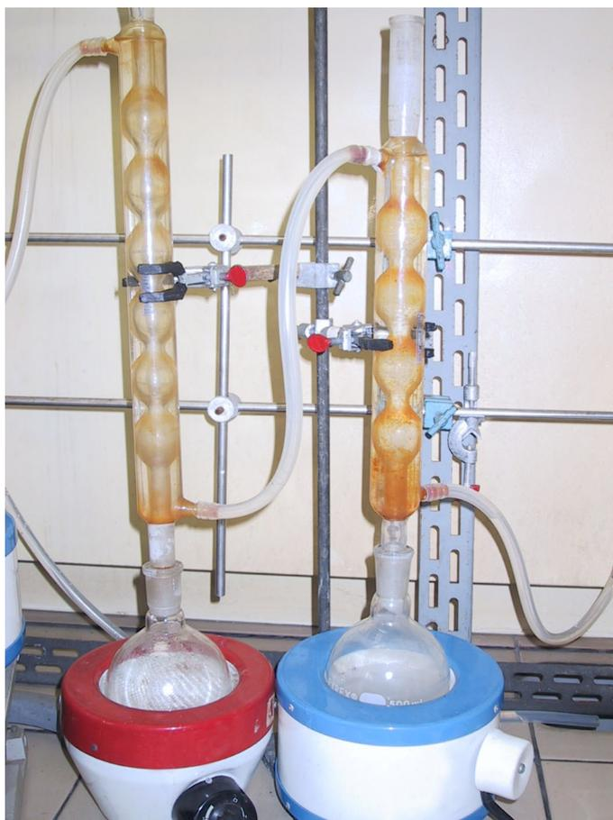
FIGURA 16 - Sistema para determinação do grau de reticulação
