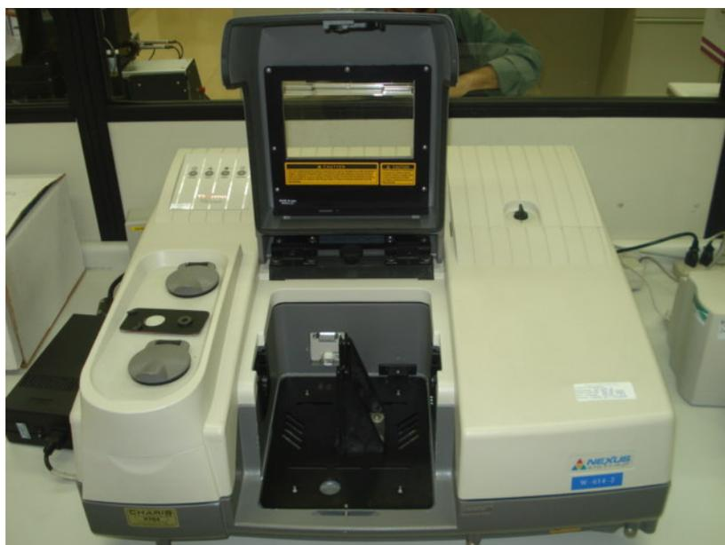
FIGURA 15 – Equipamento de Espectroscopia vibracional por infravermelho (FT-IR) marca Nicolet, modelo Nexus 670 FT-IR
