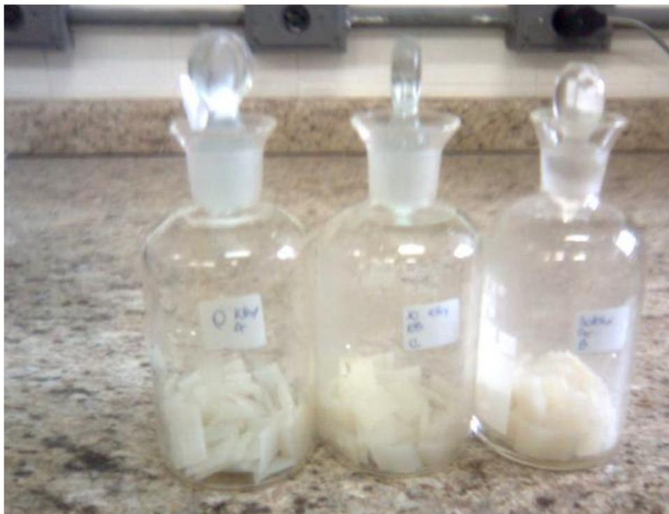
**FIGURA 9.** Amostras de embalagens após a irradiação preparadas para extração da ametrina
