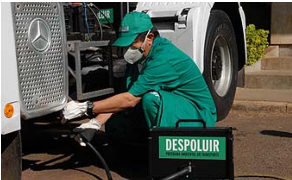
FIGURA 5: Técnico do Programa Despoluir inserindo a sonda do opacímetro no escapamento do caminhão
