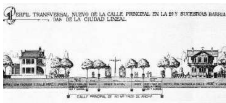
FIGURA 280 – Cidade Linear, perfil esquemático da proposta de Soria y Mata, 1898. Fonte: EATON, 2005, p. 144.
