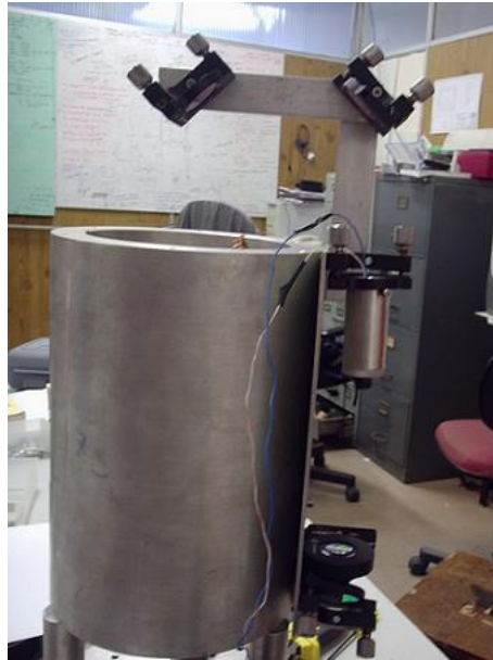
Figura 4.28: espelhos superiores em montagem feita com cantoneiras em formato “L”. O espelho superior esquerdo é responsável pela injeção do feixe na cavidade Fabry-Perot.
