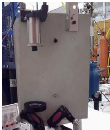
Figura 4.27: placa de duro-alumínio contendo laser de diodo, lentes e espelhos
