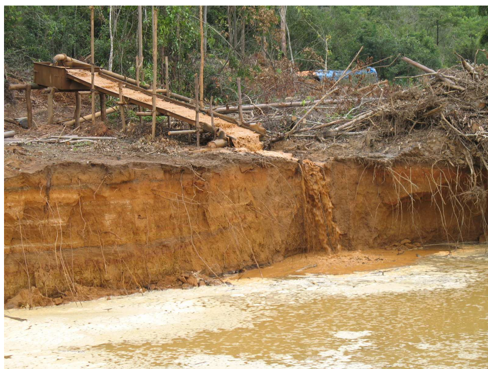
Figura16 – Bombeamento da polpa nas calhas e a perda do minério pela turbulência.
