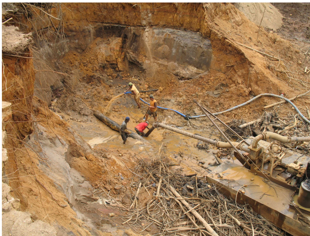
Figura 15 – Desmonte do cascalho mineralizado através do jato hidráulico.
