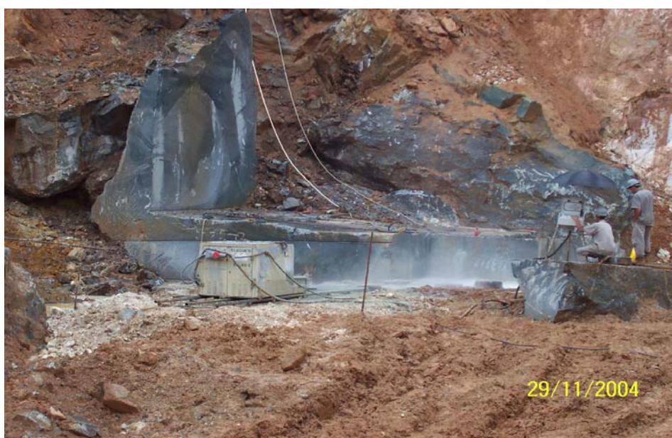
Figura 5.11 B – Máquina de fio diamantado fazendo corte horizontal. Foto: da autora.
