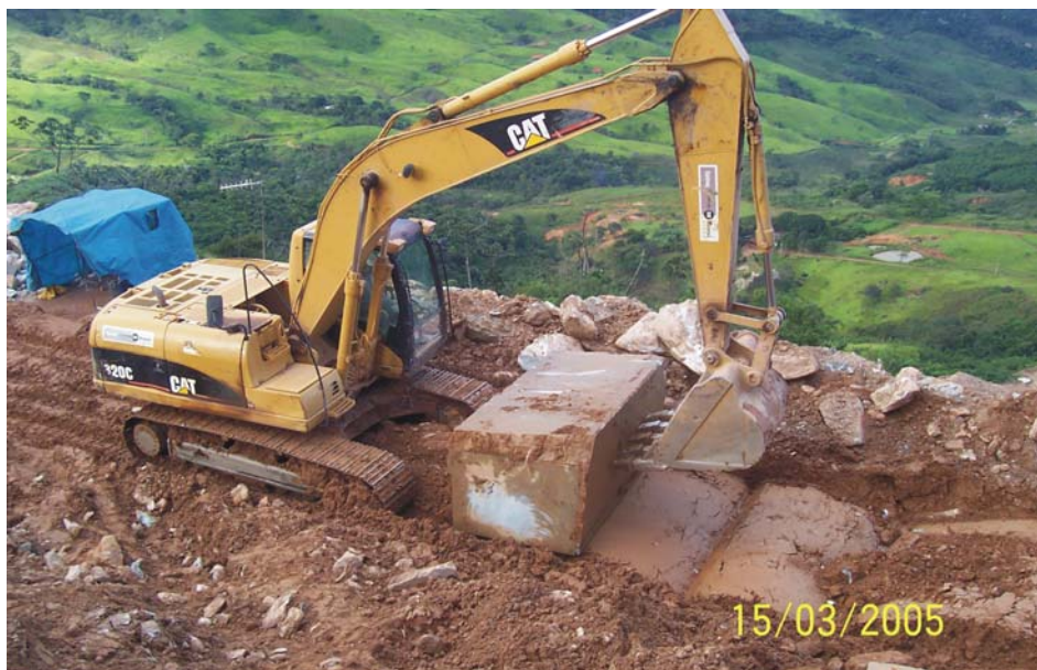
Figura 5.6 – Escavadeira de esteiras utilizada para limpeza da mina e transporte do esteatito lavrado, até o embarque. Foto: da autora.
