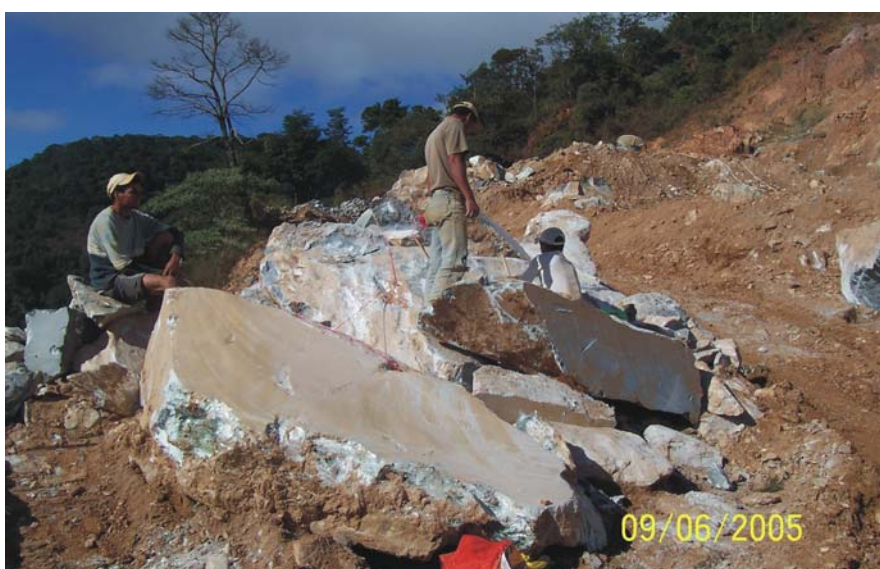
Figura 6.9 A – Garimpeiros preparando os rejeitos para desmonte Foto da autora.
