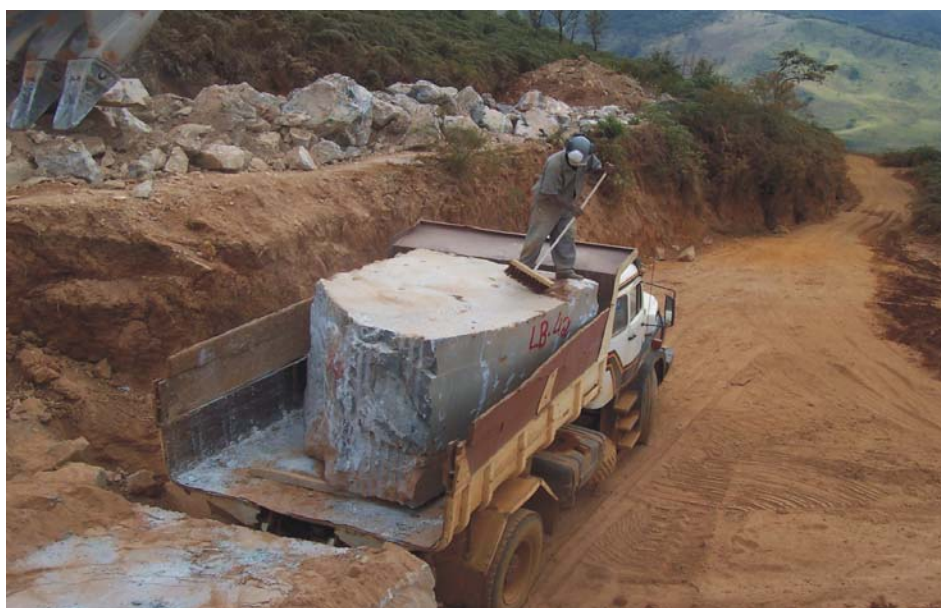
Figura 5.7 – Caminhão traçado utilizado para transporte de esteatito lavrado Foto: da autora.
