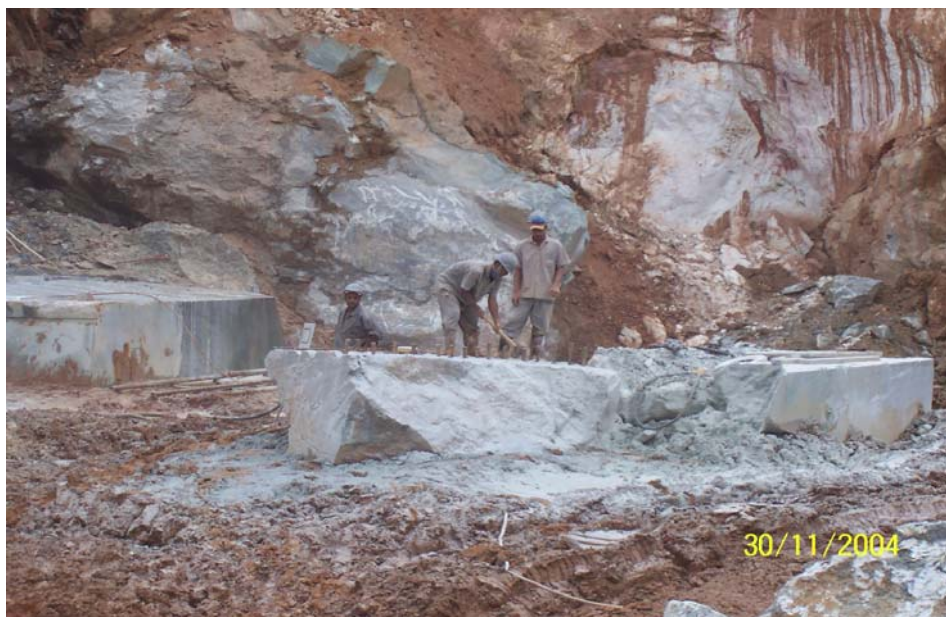
Figura 5.10 C – Trabalhadores introduzindo as cunhas de ferro nos furos. Foto: da autora.
