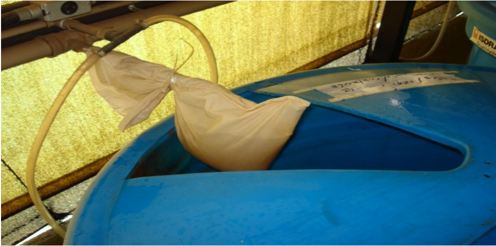
Figura 3- Filtro de malha instalado nas caixas com diferentes biomassas
