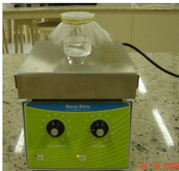
Figura 09: Esquema de agitação para obtenção das misturas de PVC com PCL pelo processo casting .
