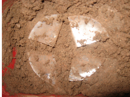
Figura 15: Esquema do ensaio de biodegradação em solo simulado.
