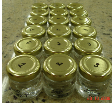
Figura 13: Recipientes em que foram submersos os filmes de PVC com diferentes porcentagens de plastificantes para ensaio de intumescimento.
