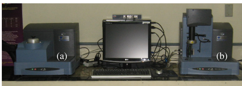
Figura 12: Aparelho empregado para determinar: a) as temperaturas de transição (DSC) e b) temperatura de degradação térmica (TG).
