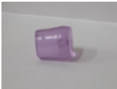
FIGURA 32 - Cristal volumétrico de Nd:YLF com 1,3 mol%, utilizado para a obtenção das amostras.
