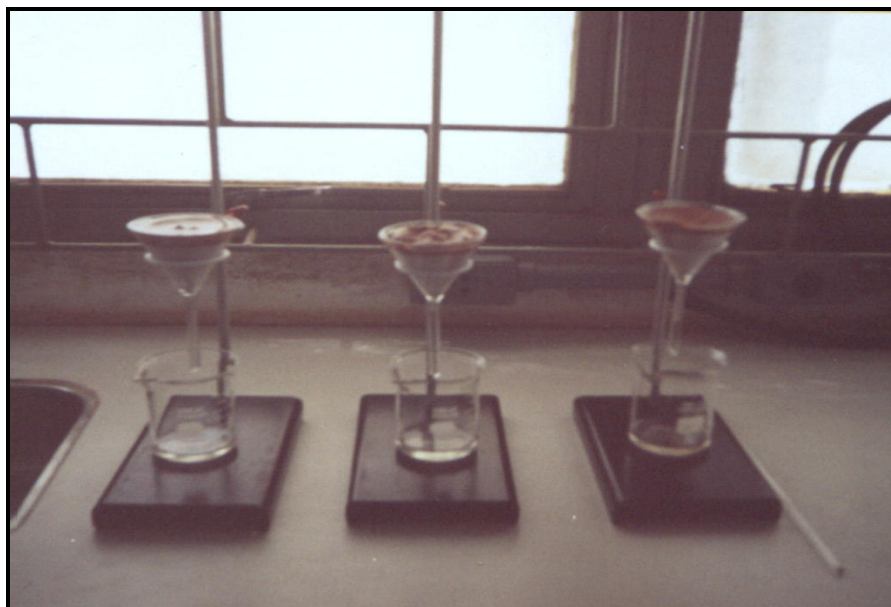
Figura 3.4 : Processo de filtragem da suspensão no ensaio de CE.
