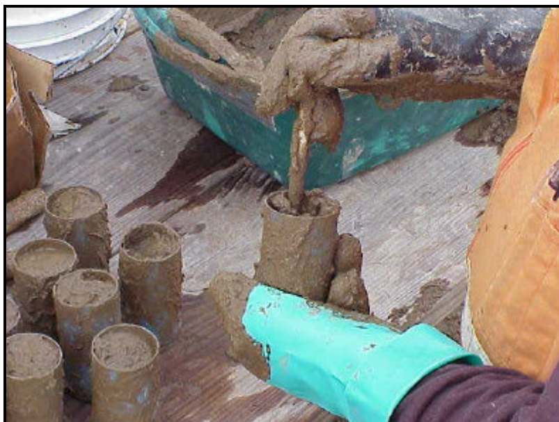
Figura 2.14 : Amostras cilíndricas do material de preenchimento SCB (Ryan & Day, 2002).
