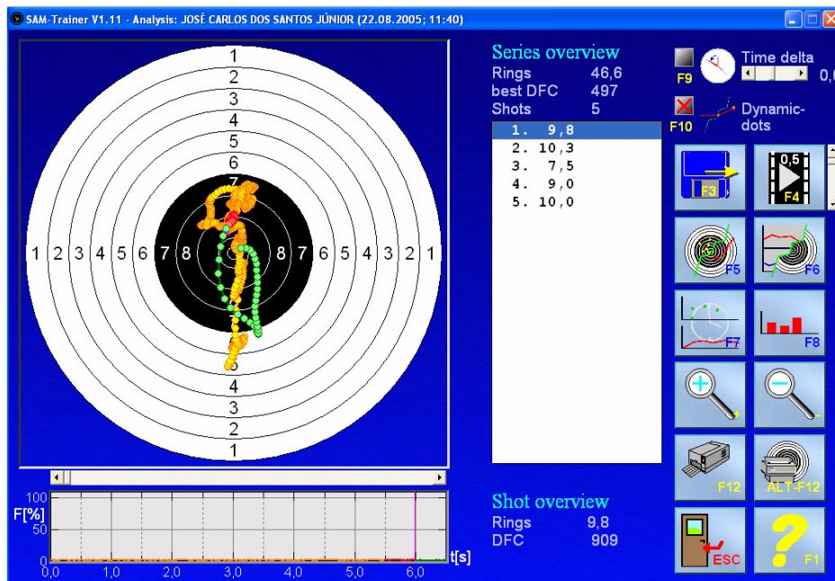
Figura 6 – Interface do programa San Trainer apresentando a trajetória da pontaria. A Linha laranja representa a posição do sensor durante os 5,5 segundos anteriores ao acionamento do gatilho; a linha vermelha representa a posição do sensor durante o acionamento do gatilho; e a linha verde a trajetória do sensor após o disparo da arma.
