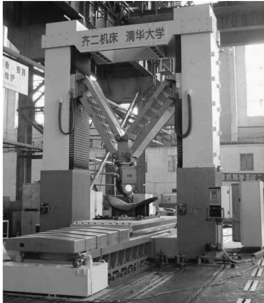
(a) Máquina ferramenta de 5 eixos com manipulador paralelo (LIU et al., 2004)
