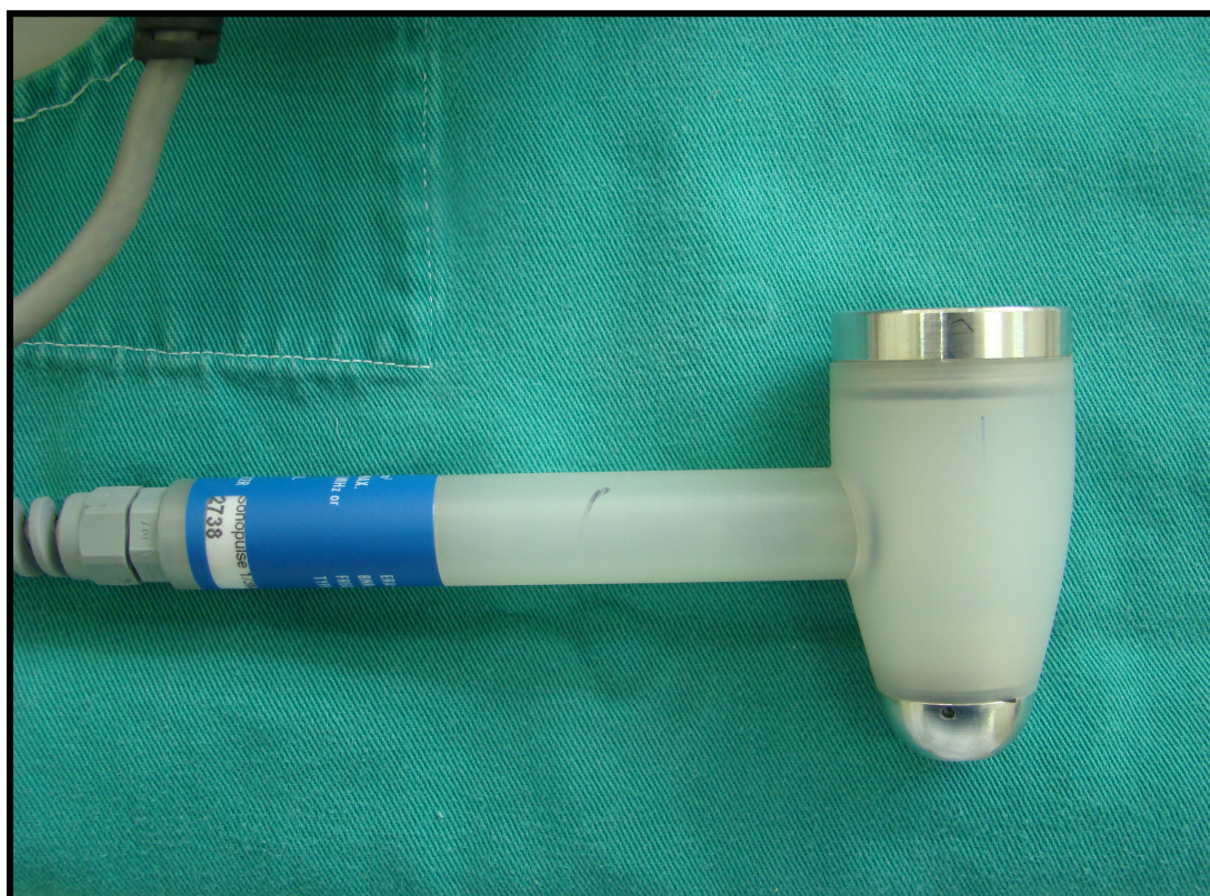
Figura 4: Cabeçote de ultra-som. Áreas de 3 e 1 cm 2
