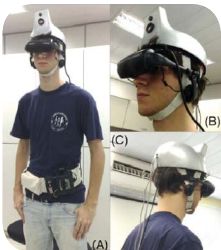
Fig. 63 (A) - Usuário equipado para utilizar o CapCam, com capacete, cinturão do miva e o HMD; (B) detalhe da cabeça - o CapCam não interfere no dispositivo de exibição adaptado à cabeça; (C) os cabos de conexão ficam por trás do usuário. [120]
