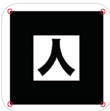
Fig. 80 - Vértices que o ARToolKit analisa para calcular a posição e orientação.
