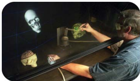
Fig. 124 - Médico modela a prótese para o crânio no PARIS™ com o instrumento contido na mão direita, um sistema de tracking virtual rastreia a posição da mão esquerda. O modelo real do crânio vai se tornado visível na tela. [168]
