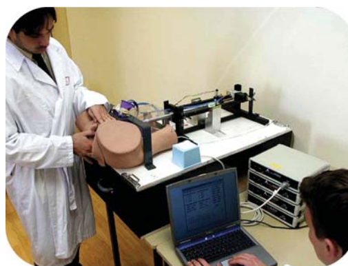
Fig. 38 - O simulador de parto inclui 4 partes: um manequim fetal representando o cabeça de um feto a termo, um manequim, um sistema de interface baseado em pressão e um sistema de localização. [65]
