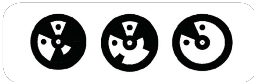
Fig. 85 - Marcadores fiduciais com código de barras 101, 1967, 32767. [138]
