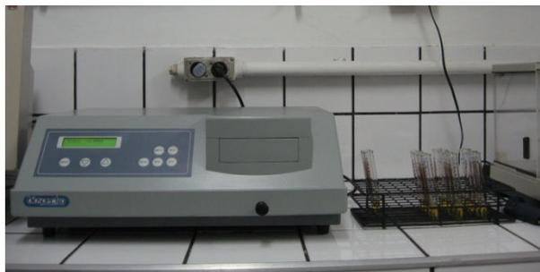
**Figura 8:** Espectrofotômetro no qual as dosagens bioquímicas foram realizadas.
