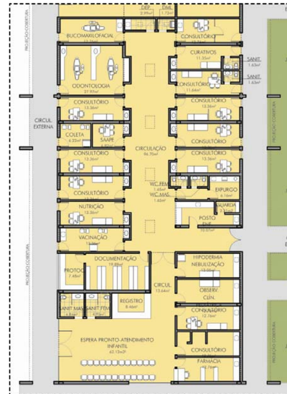
Figura 25 - Planta Humanizada Bloco A (parte1 - atual)
