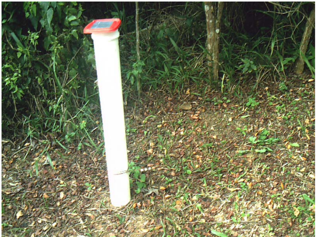
Figura 18: “tóten” conjunto de suporte de plaqueta, plaqueta, linha-guia e guizos. Fonte: arquivo pessoal (2008).
