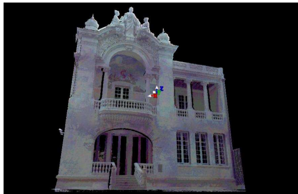
Figura 24: Exemplo de imagem capturada por scanner – nuvem de pontos.
