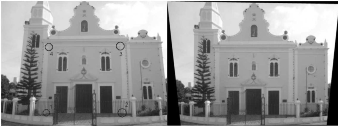
Figura 33: Exemplo de uma fotografia com distorções e posteriormente retificada.
