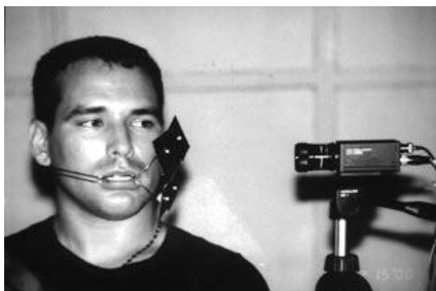
Figura 9: Disposição da câmera de vídeo e dos quatro marcadores construídos com esferas de acrílico branco sobre pedaços de papel preto, presos a um arco extra-oral. (Missaka et al. , 2008).
