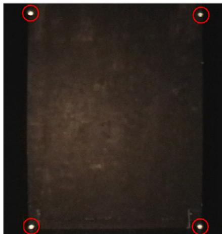
Figura 09: Calibrador de 4 pontos do sistema de cinemetria.
