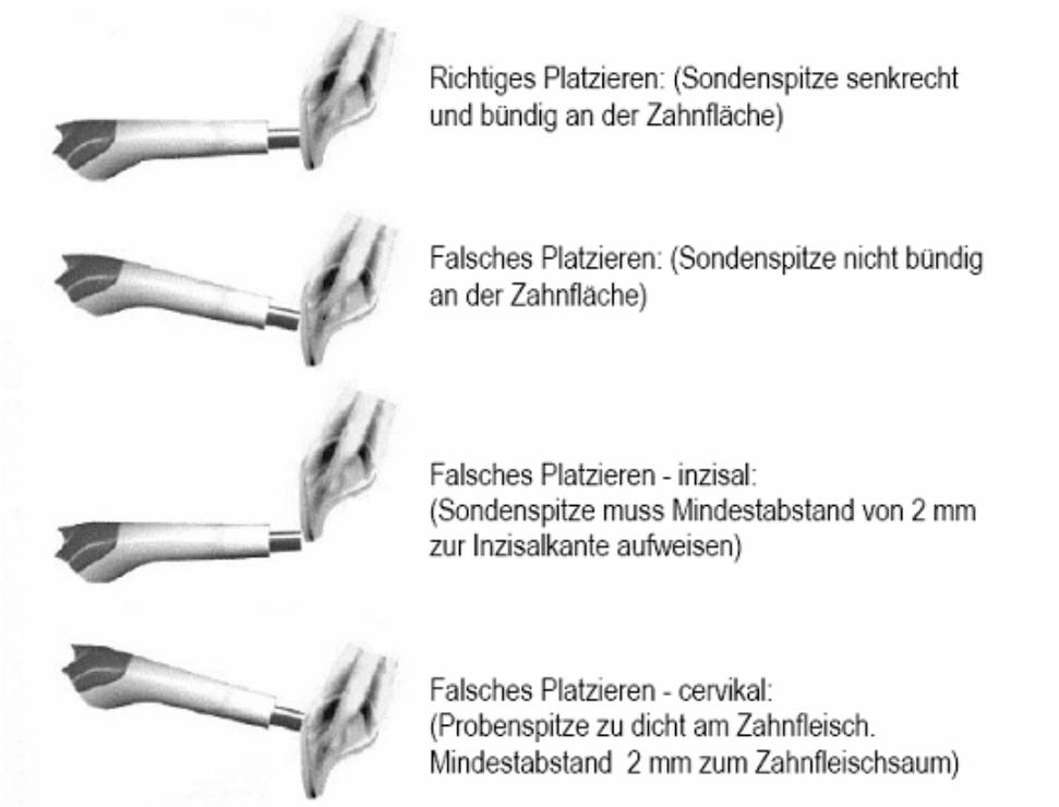
Figura 1 - Forma de posicionar o espectrofotômetro para leitura da cor dental, apenas o primeiro desenho está correto.
