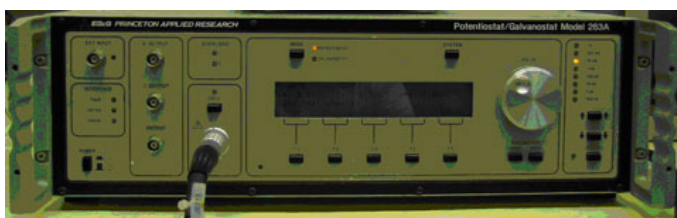
FIGURA 2.14 – Potenciostato/Galvanostato da EG & G PARC modelo 263 e Microbalança de cristal de quartzo SEIKO EG & G modelo QCA917.
