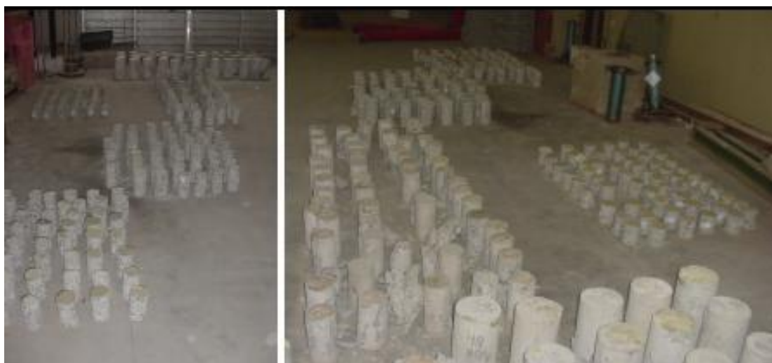
Figura 4.17- Visão geral das amostras após o ensaio de resistência à compressão.
