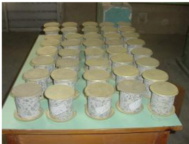
Figura 4.15- Testemunhos devidamente capeados.
