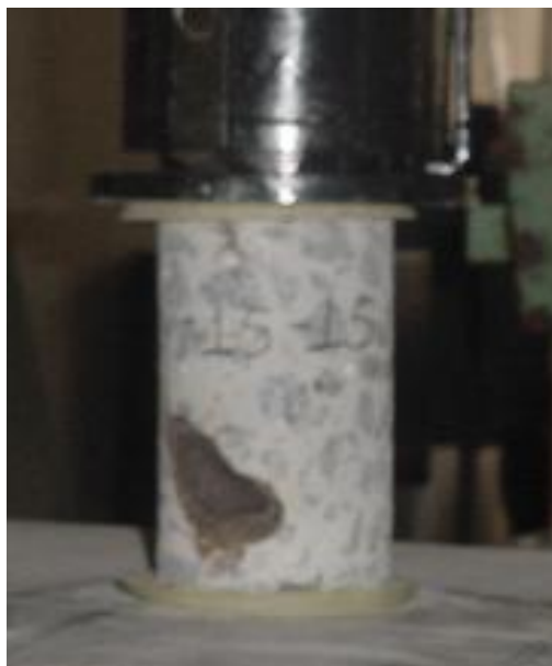
Figura 4.14- Testemunho de n°. 15, extraído do bloco EN-15, com a presença de um agregado argiloso.
