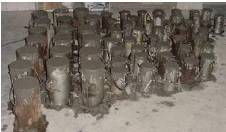
Figura 4.10- CP's de referência após a concretagem.
