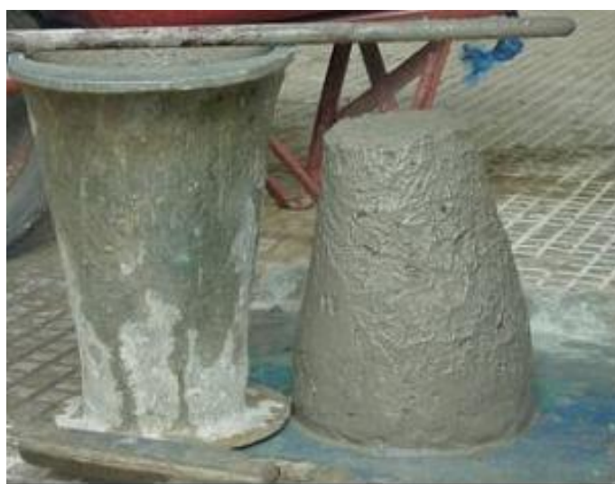
Figura 4.7- Determinação da consistência pelo abatimento do tronco de cone.
