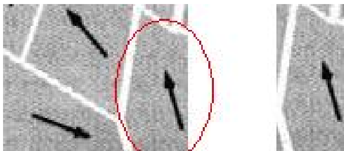
Figura 2.10: Domínios magnéticos de um material. As setas representam a direção da magnetização no domínio específico. As linhas brancas representam as paredes de domínios. Mesmo que o material tenha vários domínios sua magnetização é diferente de zero.
